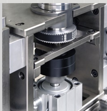
Höhenverstellbare Sägeblattaufnahme Height adjustable saw blade holder
